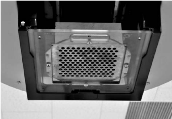
図5 空間的分割グリッド照射に用いるグリッドブロック このグリッドブロックを射出部に装着し、グリッド状のX線を得る。
