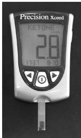
図2 \beta -ヒドロキシ酪酸濃度のポータブル測定器 現場でカートリッジに全血をしみ込ませて簡単に測定できる
