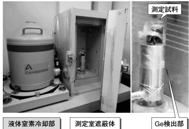
図1 北里大学のゲルマニウム半導体検出器
